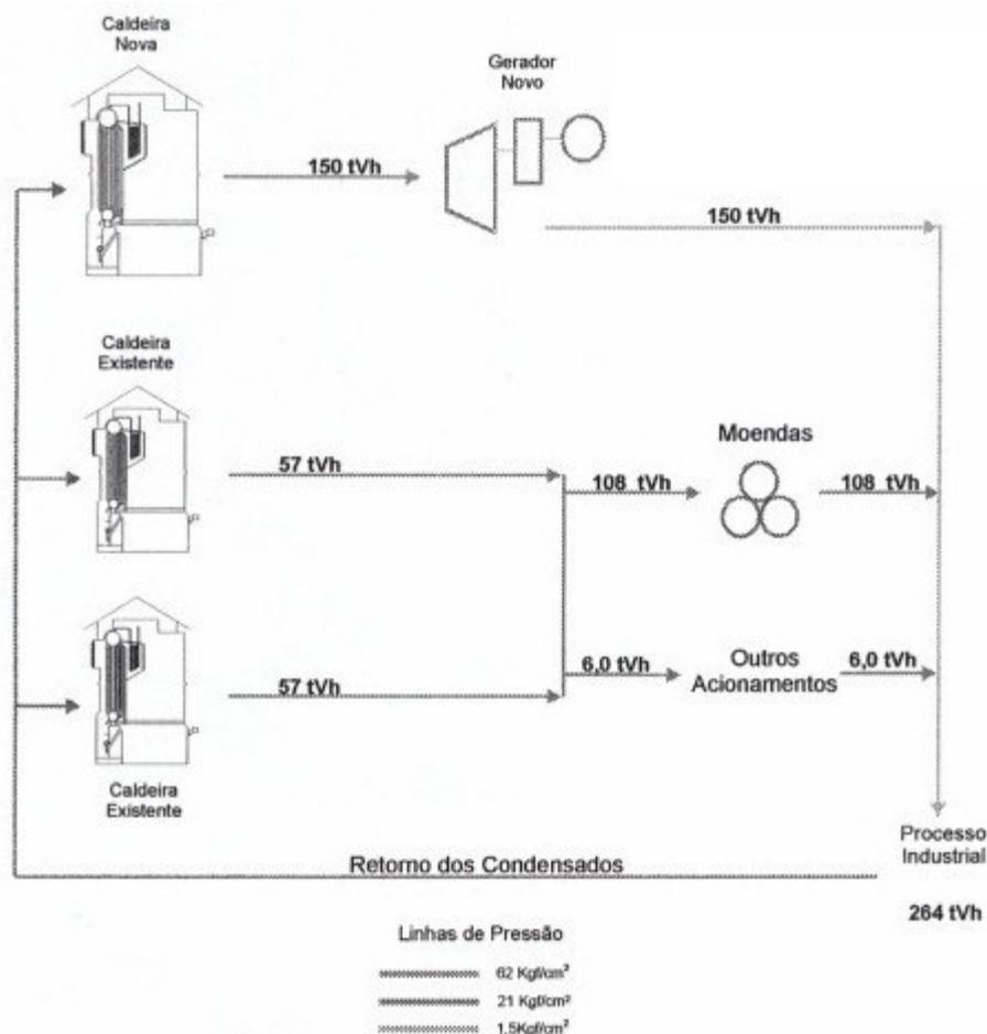
Figura 4. Diagrama de Balanço de Energia para a Fase 1
