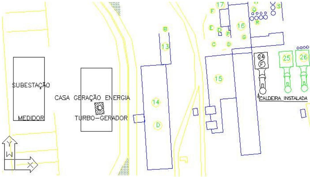
Figura 3. Diagrama esquemático dos equipamentos instalados para cogeração com bagaço em cerradinho
