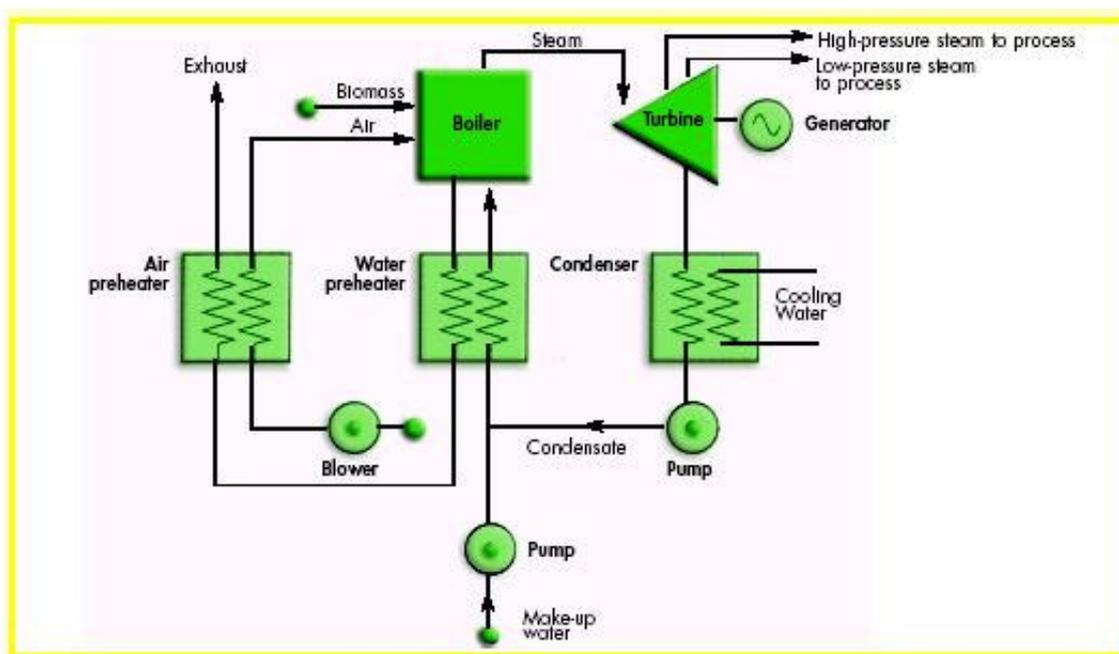
Figura 2. Diagrama esquemático de um ciclo de vapor Rankine para cogeração usando uma turbina de extração-condensação
