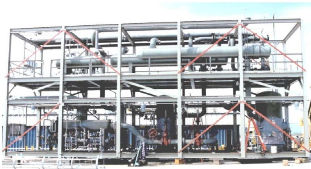
Figura 5 Exemplo de estação de “upgrade” como a que será implementada no CTR Santa Rosa. Imagem obtida em folheto da empresa Linde.
