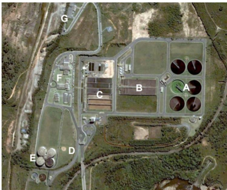
**Figura 1.** Vista aérea da ETE Arrudas (Data da imagem: 12/05/2007). A) Entrada principal B) Instalações de suporte e de controle C) Digestores anaeróbios D) Queimadores de biogás E) Decantador primário F) Reator Aeróbio G) Decantador Secundário
