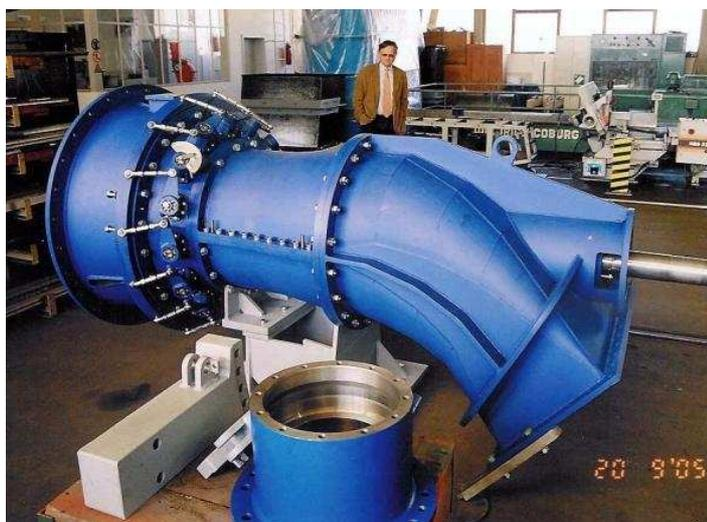
**Figura 2 - Exemplo de uma turbina Kaplan<sup>9</sup>**
