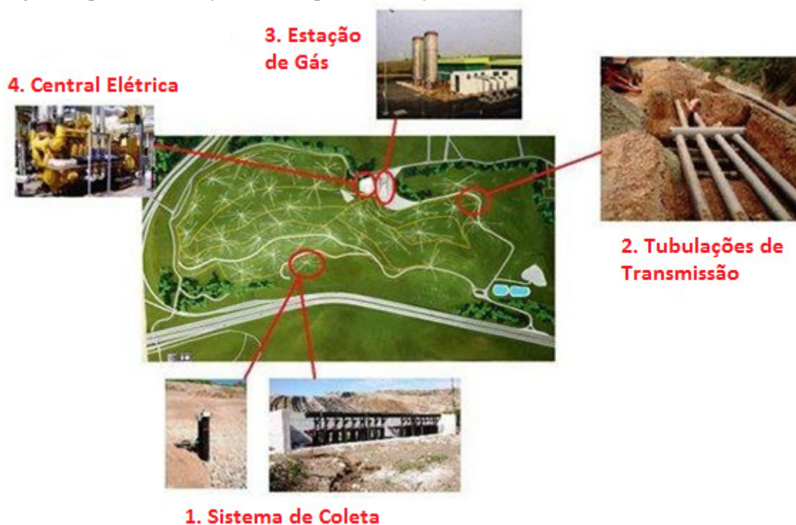
Figura 3: Situação esquemática de um aterro sanitário com recuperação ativa de gás.
