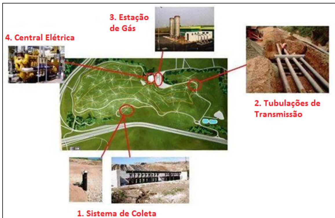
Figura 3: Situação esquemática de um aterro sanitário com recuperação ativa de gás.
