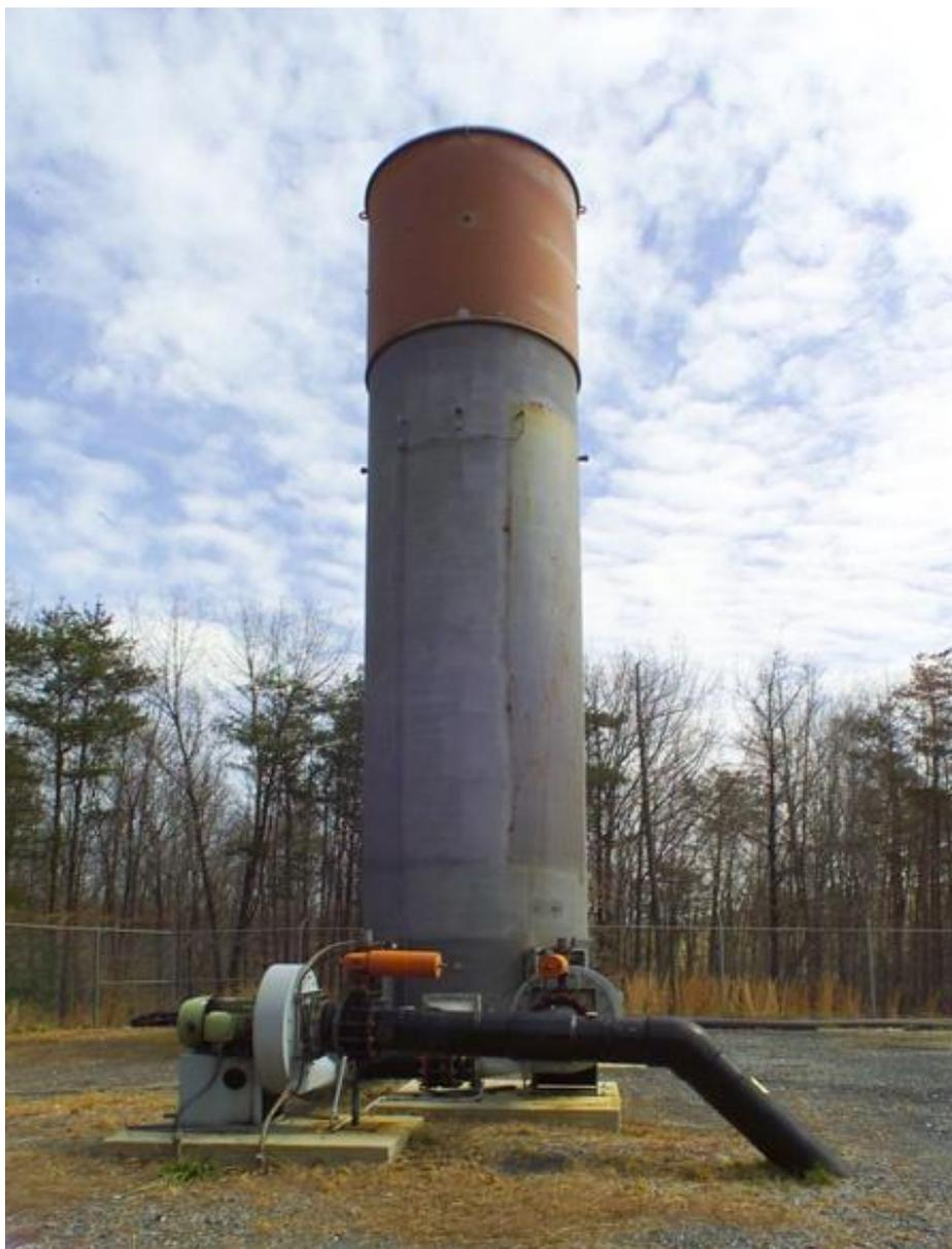
**Figura 7 - Detalhe do sistema de queima (queimador fechado)**
