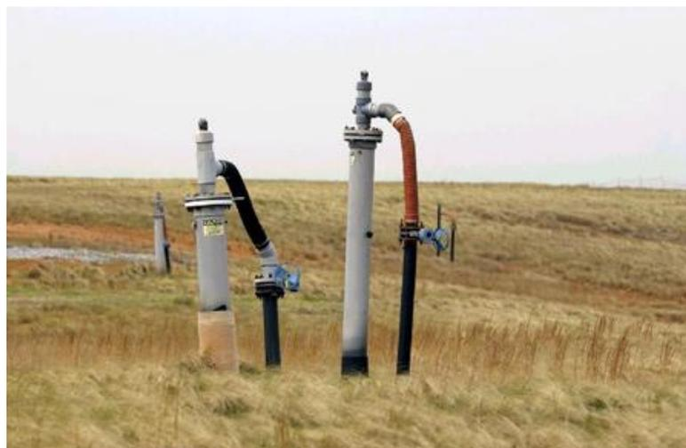
**Figura 4 - Exemplo de sistema de coleta (cabeçotes)**
