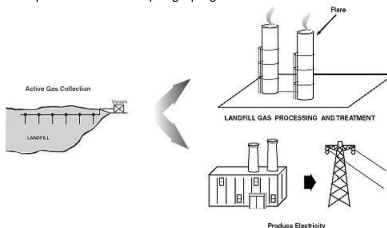
**Figura 8 – Diagrama de geração de energia**
