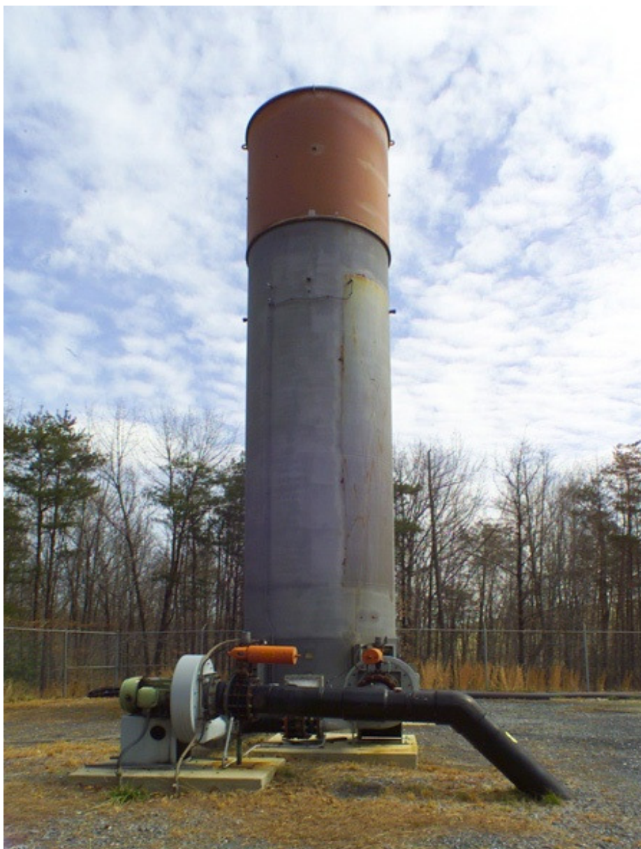
Figura 6 - Detalhe de um flare fechado
