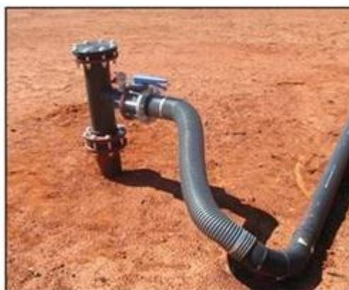
**Figura 3 - Exemplo de cabeça de poço**
