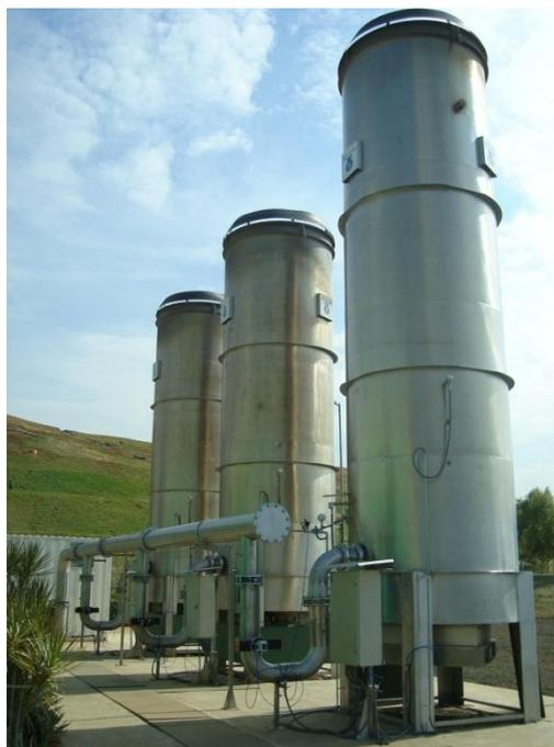
**Figura 6 - Detalhe de um flare fechado**
