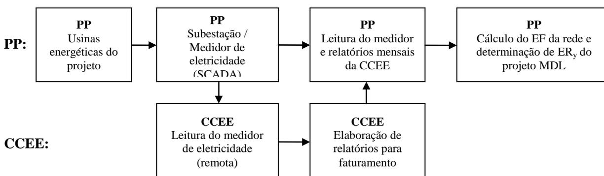
**Figura 5. Processo de monitoramento da atividade de projeto proposta. O total de energia de todos os subprojetos será medido na subestação, que é também o ponto de interligação à rede (isto é, a energia não é medida para os subprojetos individualmente).**
