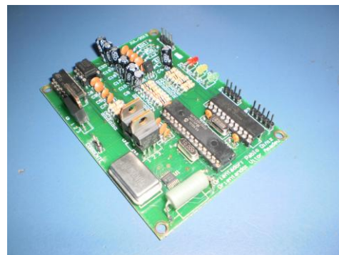
Protótipo da fonte fabricado em uma placa de circuito impresso
