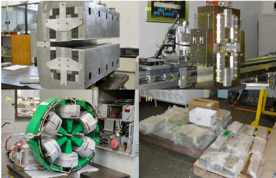
Figura 5: Protótipos dos principais ímãs de Sirius. a) Dipolo de baixo campo e (b) dipolo de alto campo, ambos de magnetos permanentes; (c) sextupolo, que é um eletroímã puro e (d) peças do quadrupolo, ímã híbrido que está em fase de montagem
