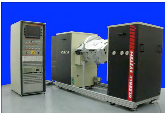
Figura 3: Gleeble - Simulador termomecânico adaptado para radiação síncrotron
