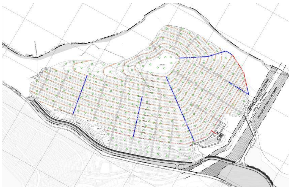
Figura 3 - Vista geral dos sistemas de captação e coleta de LFG e da estação de queima em flare.
