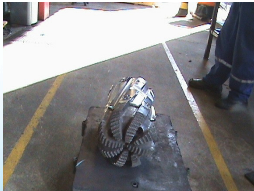
Broca de perfuração de poços de petróleo de 230 mm de diâmetros
