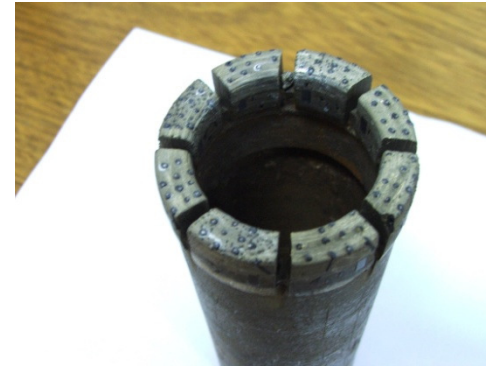
Broca anelar de 100 mm de diâmetro (usada) 2,5 X mais durável
