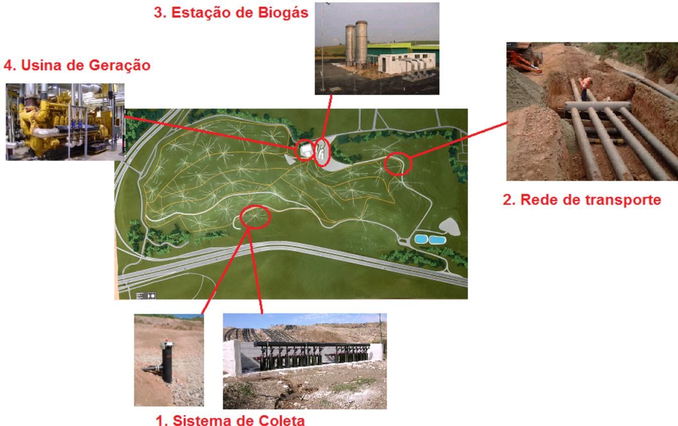
**Figura 2. Situação esquemática de um sistema ativo de recuperação de biogás de aterro e geração de energia**
