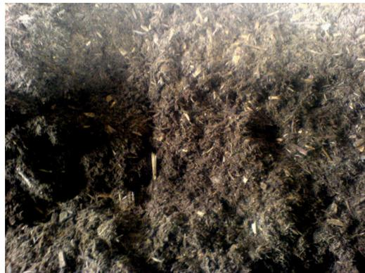
**Figura 4** - Mistura cavaco de madeira e cana-de-açúcar
