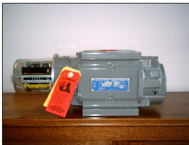
Figura 2. Medidor de fluxo de gás “Roots”
