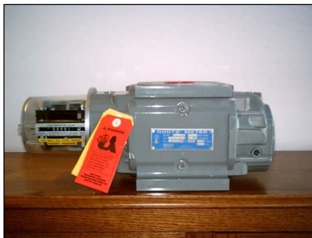
Figura 2. Medidor de vazão de biogás “Roots”
