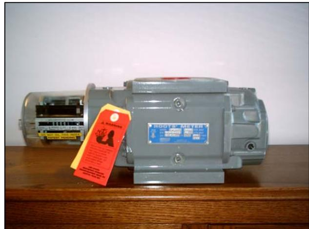
Figura 2. Medidor de vazão de biogás “Roots”
