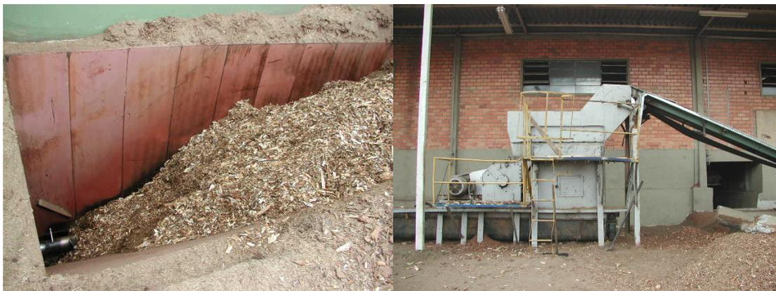
**Figuras 4 e 5: Moega Schiffer e repicador Planalto como nova tecnologia adquirida para o tratamento dos resíduos combustíveis.**
