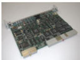
Placa (6 camadas) contendo 16 troncos T1/E1, matriz de comutação, protocolos de rede (ISUP, RDSI, MFC, R2 digital, etc), sinalização acústica, bilhetagem, sincronismo, e todas as demais funções requeridas por uma central digital
