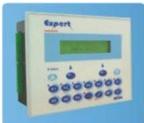
A série Expert é composta por Controladores Programáveis com Interface Homem-Máquina incorporada com capacidade de 8 E / 8 S ou 20 E / 12 S digitais, sendo que os modelos 8 E / 8 S
